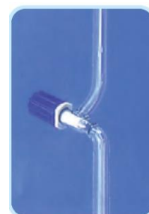
Кран, прямой, с игольчатым клапаном с ключом из ПТФЭ (Rotaflow)
