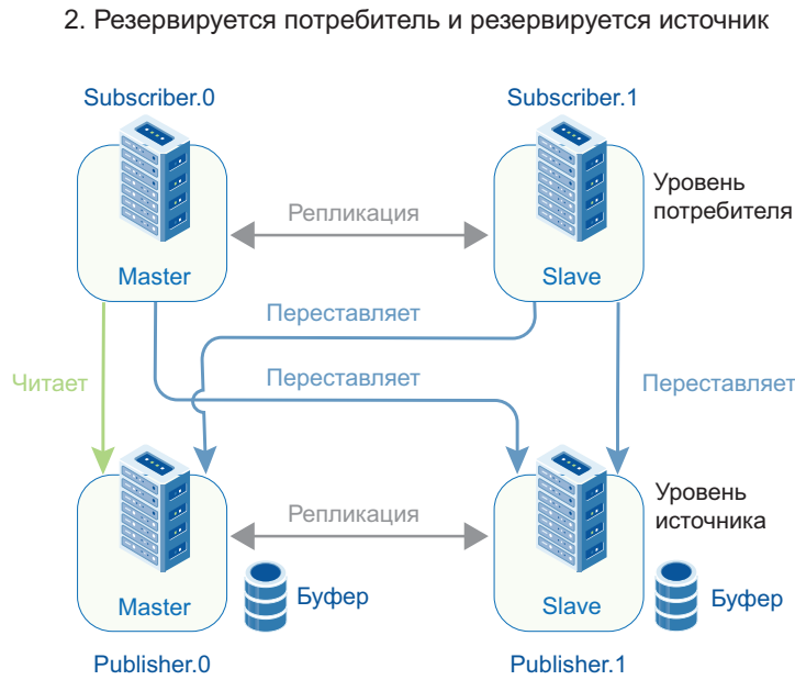
РИС. 8. ► Буферизация для схемы с резервированием источника и потребителя
